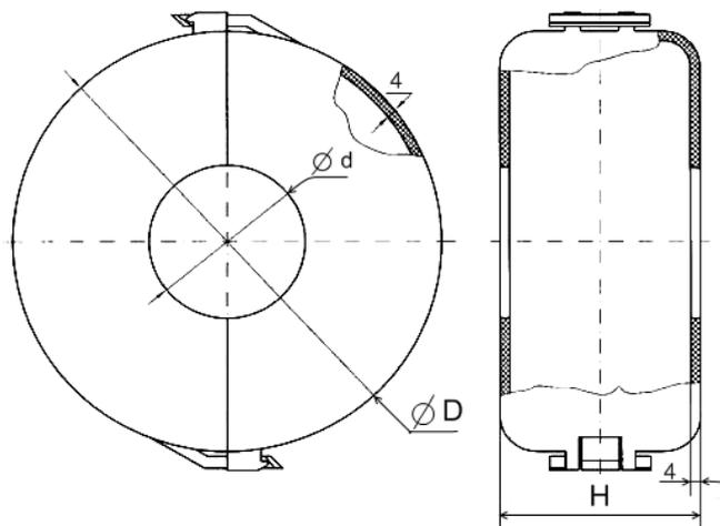
Кожух защитный полиэтиленовый КЗП исполнение 1
