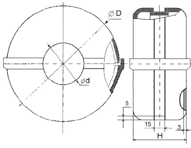
Кожух защитный полиэтиленовый КЗП исполнение 2
